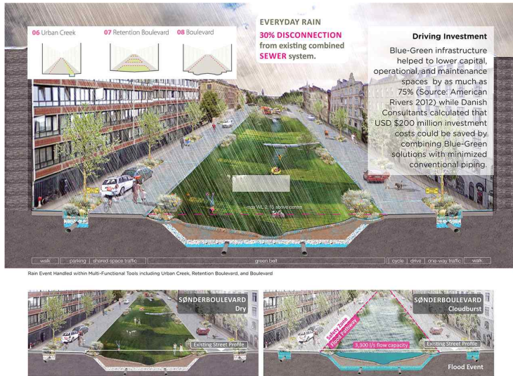
그림 13. 코펜하겐의 지속 가능한 도시 배수 시스템 조감도 (출처 : American Society of Landscape Architects 홈페이지)
