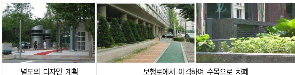
[그림 2-6-1] 환기구 설치 예시도
