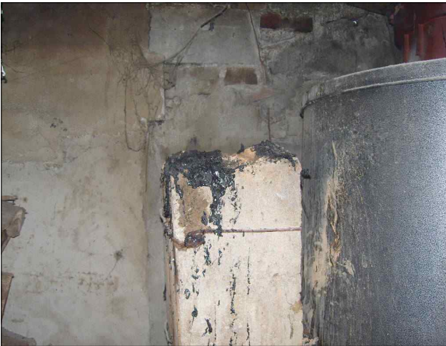
사진 3-1. PVC재질 연통이 녹아내린 잔해물과 보일러 연통이 외부로 통하는 지붕 소훼상태
