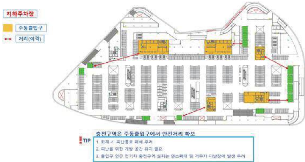
〈그림 10〉 주동 출입구와 안전거리 확보 예시
