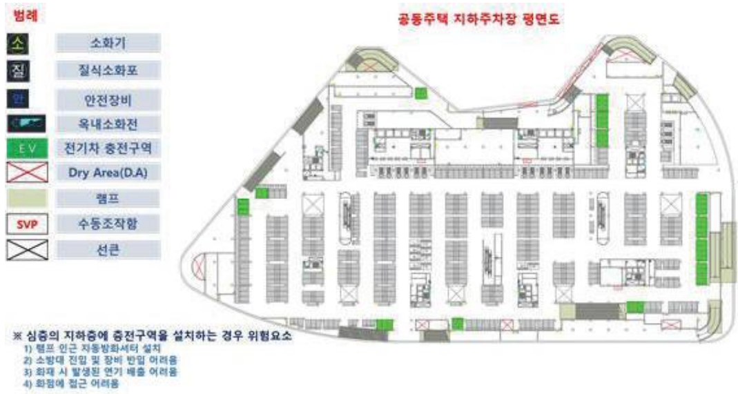
〈그림 9〉 지하주차장 충전구역 위치도 예시
