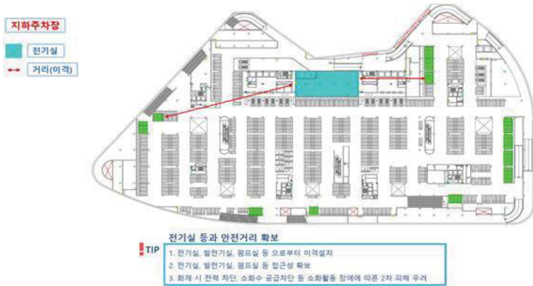
〈그림 12〉 전기실 등과 안전거리 확보 예시
