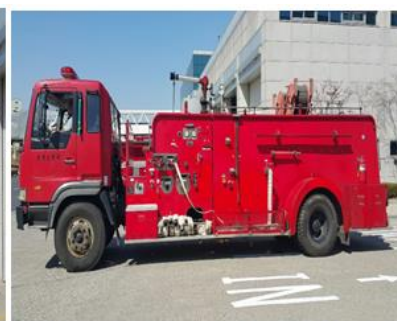
방수용량: 1,000GPM, 2대 보유 품적재량 3,400L
