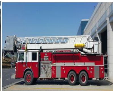
방수용량: 2,000GPM, 사다리:26M 품적재량 4,000L
