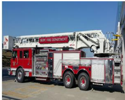
방수용량: 3,000GPM, 사다리:30M 품적재량 9,000L
